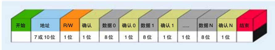
图 5.1. I 2 C 消息结构。
