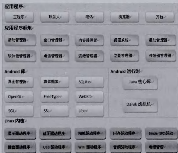
图1 Android系统架构图
